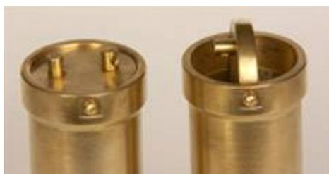
**Назначение:** пробоотборник ПН-2 и ПН-3 предназначены для отбора проб из резервуаров, хранилищ, емкостей, (в т.ч. придонных) с заданной глубины до 10 м.
